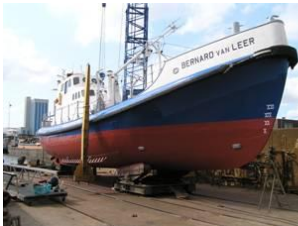
Zinkanodes aangebracht, onderwaterschip twee maal in de anti-fouling en bovenwater twee nieuwe lagen Hempel blauw.
