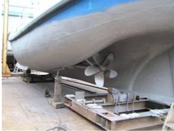
Gehele onderwaterschip tot ver boven de waterlijn in twee componenten primer gespoten.
